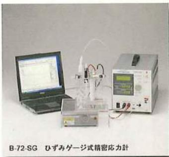
B-72-SG ひずみゲージ式精密応力計
