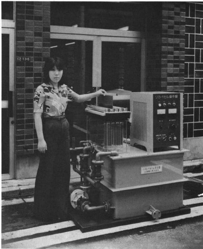
リカバセルは重金属を含むめつき液、前後処理液、水洗液の中に含まれている重金属イオンを効率よく金属として回収することを目的とした画期的な小型金属電解回収装置です。この装置は中村経営研究所のクロースドシステム“MEWS”に不可欠の機器として開発されたもので、その
